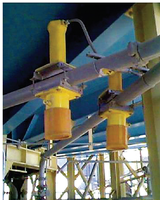
Фиг. 13. Измервателен уред с ^{241}\text{Am} , монтиран на поточна линия за пълнене на кенове
