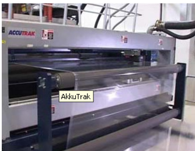
Фигура 10. Дебеломер за измерване дебелина на фолио
