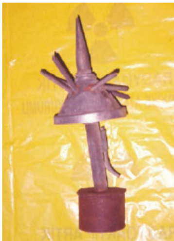
Фиг.29. Радиоизотопен гръмоотвод
