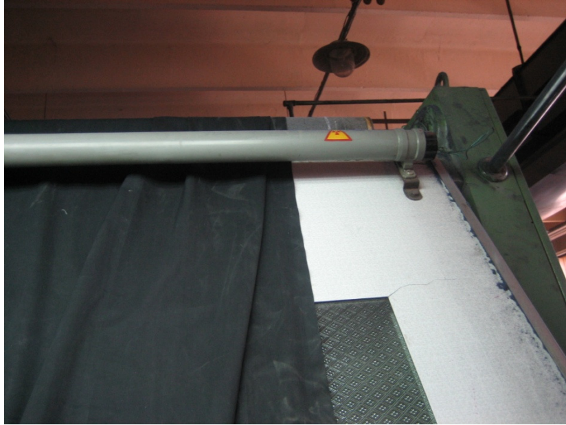
Фиг. 27. Неутрализатор на статично електричество в затворено състояние “Струматекс” АД Благоевград
