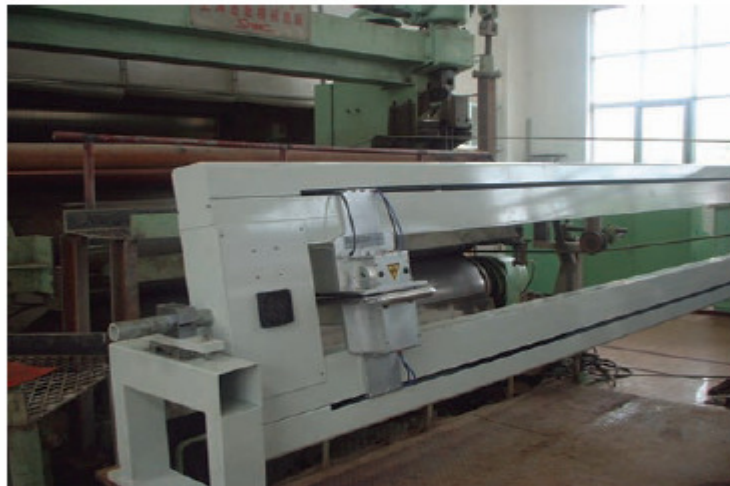
Фигура 8. Уред за измерване дебелина на тъкани и хартия
