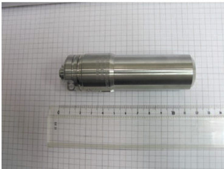
Фигура 13. Тръба с Cs 137 източник за каротаж на нефтен кладенец
