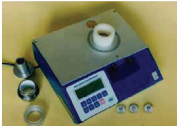
Фигура 24. Преносим анализатор с източници Cd-109, Am-241
