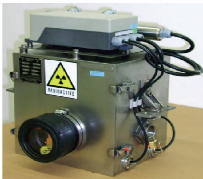
Фигура 20 Уред за измерване на влага в насипен материал
