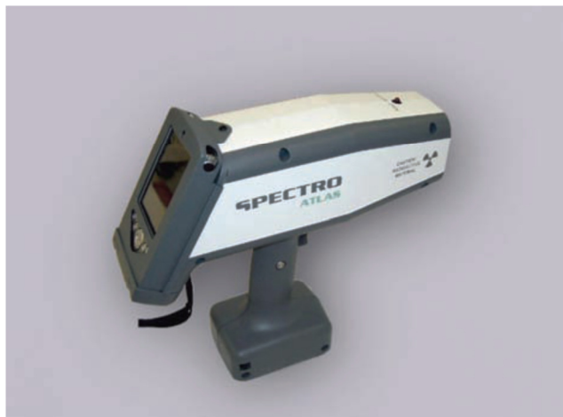
Фигура 25. Ръчен уред за РФА с рентгенова тръба
