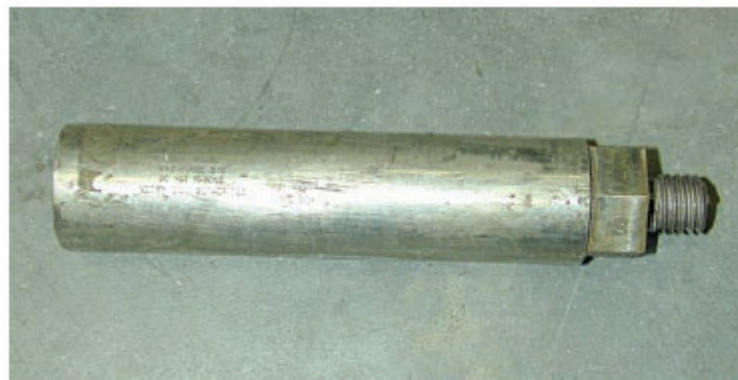
Фигура 17. Неутронен източник с ^{238}\text{Pu}/\text{Be} за каротаж на нефтен кладенец
