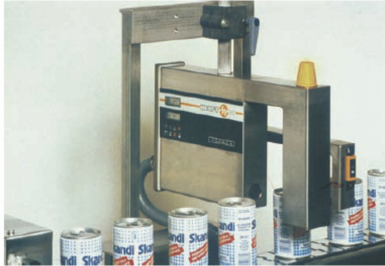
Фиг. 11. Измервателен уред с ^{241}\text{Am} , монтиран на поточна линия за пълнене на кенове
