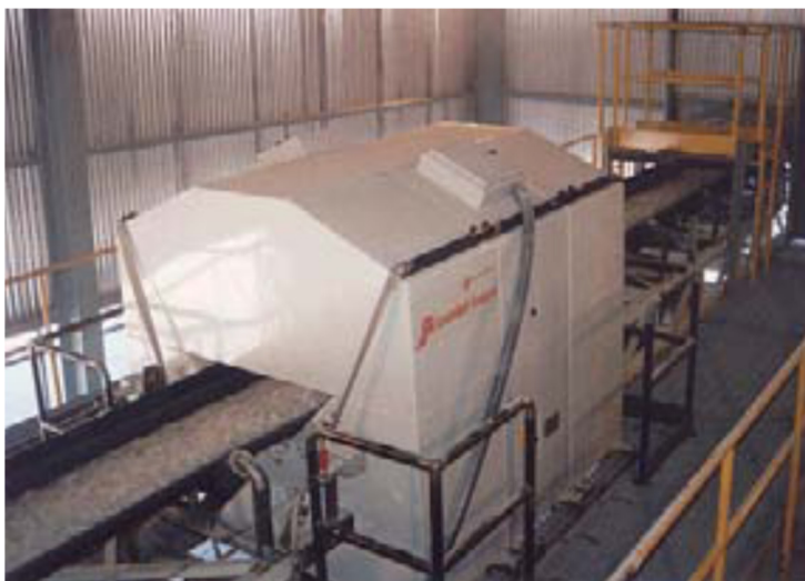
Фиг. 21. Система за неутронен активационен анализ, монтирана на конвейерна линия в завод за цимент
